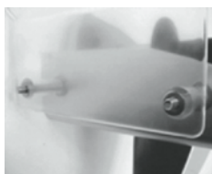
3. Inserire le due rondelle sui bulloni.
