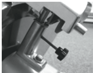
3. Borg de slijpvoorziening aan de machine door de borging aan te draaien. Controleer of de slijpvoorziening vast zit voordat u de machine in gebruik neemt.
