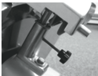
3. Затяните ручку, чтобы заточивающее устройство было неподвижным. Перед использованием устройства убедитесь, что заточивающее устройство надежно закреплено.
